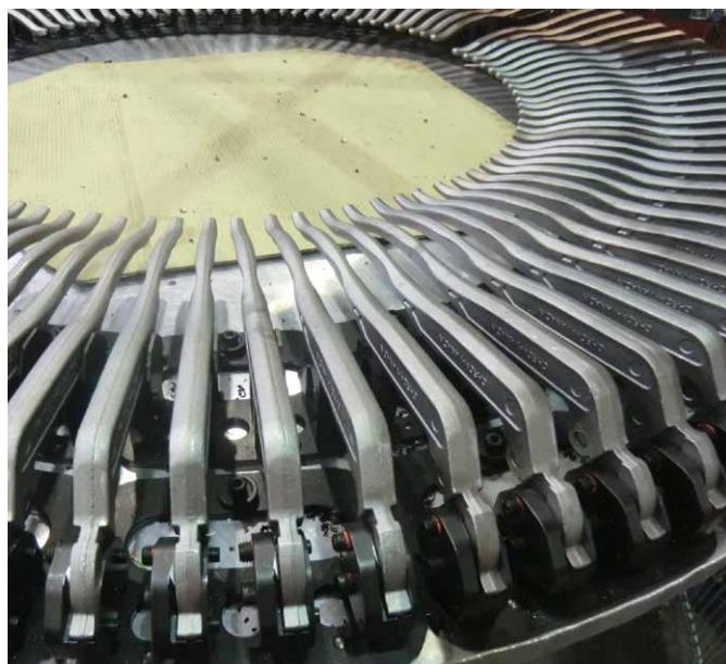
automatisierte Fertigung von Rohrzangen, Nageleisen und Meißeln
